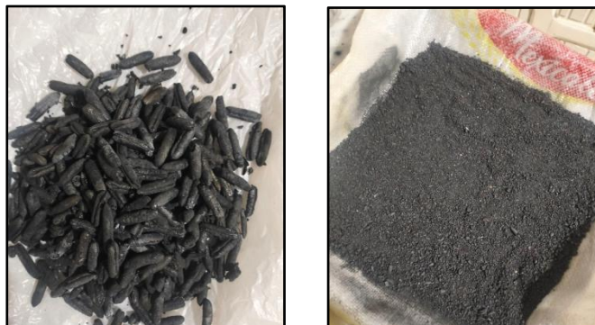
Figure 2: Calcination des noix de datte par pyrolyse
